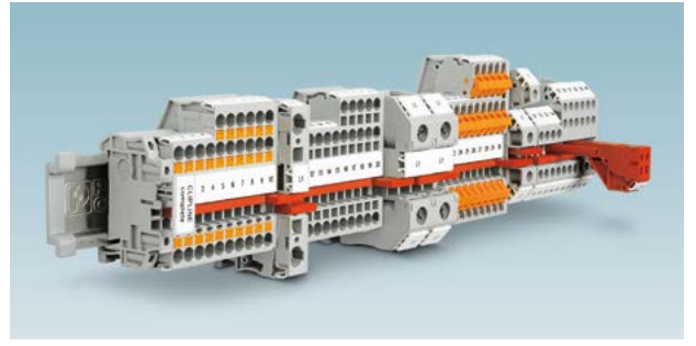
Resim 3: Phoenix Contact'ın Cipline complete sisteminde yer alan çoğu klemens, bağlantı yönteminden bağımsız olarak, ATEX ve IECEx tarafından patlama koruma sınıfı Ex e için onaylanmıştır.
