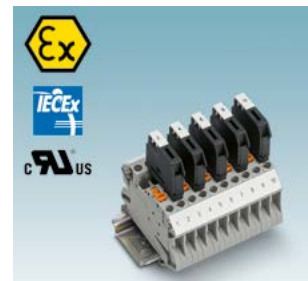
Resim 4: Ex nA patlama koruma sınıfı onaylı ayırma klemensleri ve sigortalı klemensler, Bölge 2'deki büyük akımları ölçmek veya bir sigorta vasıtasıyla bunları sınırlandırmak için uygundur.
