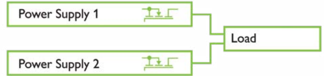
Resim 3: Yaygın standart güç kaynaklarının çıkış gerilimi bir regülasyon arızası durumunda 35 V'a kadar çıkabilir ve yükler zarar görebilir.
